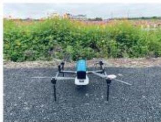
致睿外业团队使用睿影RS100飞行平台搭载迅影X8 PRO镜头，进行外业数据采集。珠海项目的测区面积为110km<sup>2</sup>，测区的高楼区密集区域已超过330m，为保证安全的情况下同时保证高楼顶部重叠率足够，采用区块挑高飞行，使成图质量更高。此次累计总航飞架次为285个，累计作业天数为22天。
