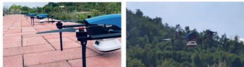
本项目的测量面积为94km<sup>2</sup>，根据飞行区域分为城区以及山区。其中包括一些高楼区，当楼高超过80M，在保证精度和设备安全的前提下，采用“双层航飞法”，可达到超高建筑的高处建模完整；山区面积总体为69.85KM<sup>2</sup>，因需要仿地飞行效率较于正常飞行低许多，依照飞行理想情况下，预计飞行架次不低于220个架次。
